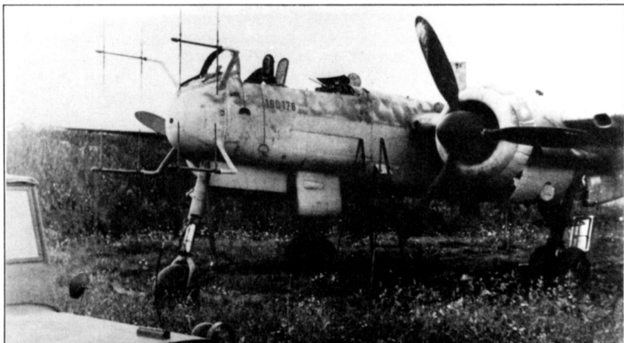
OBEN : Kurz nach Kriegsende wurde die He 219 A-7, Werknummer 190 176, in Lechfeld aufgenommen. Aus dem Cockpit ragen die Kopfstützen der beiden Katapultsitze. (Sammlung US Air Force via Petrick)
